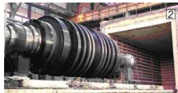
1 – устаткування для хіміко-термічної обробки, 2 – азотування в шахтній печі
